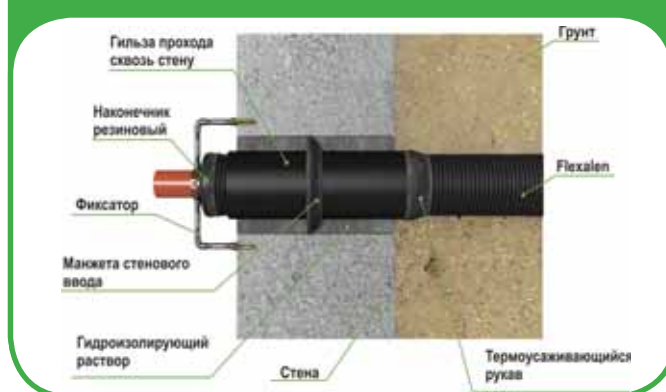
4. Проход сквозь стену FD-MD...DRS
