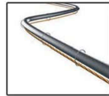
Прокладка кабеля вдоль труб
